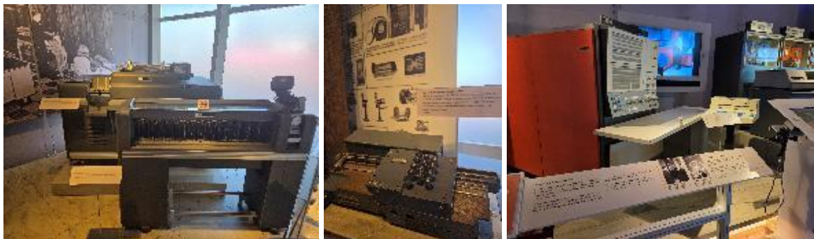
Stânga: Echipamente IBM pentru prelucrarea cartelor perforate, inclusiv mașina de sortat IBM Type 82 și tabulatorul IBM 403. Centru: Mașină IBM Type 11 Electric Key Punch (1923), utilizată pentru perforarea cartelor destinate prelucrării automate a datelor. Dreapta: Calculator IBM System/360. Foto: Catalin Vrabie, 2026.
