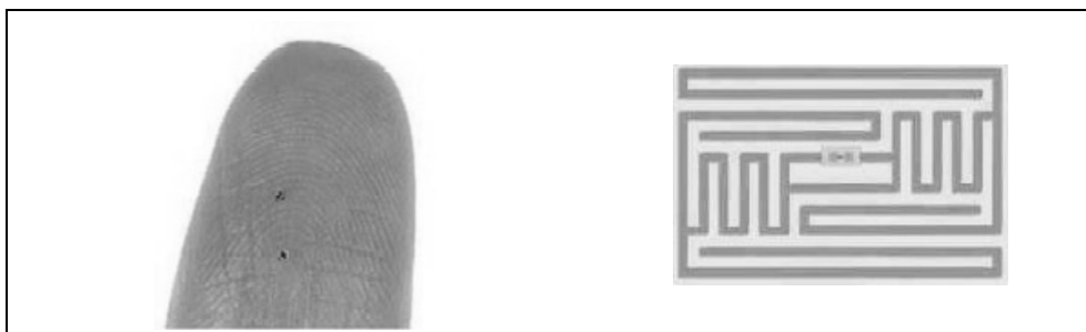
Figura 2. Tagul RFID (stânga) și Chip + antena (dreapta) - zoom;
