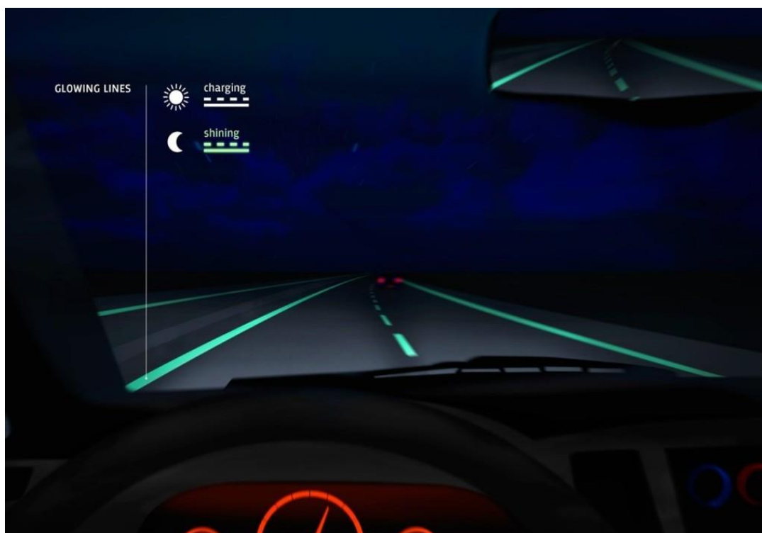
Fig. 8. Sistem de marcaje stradale care noaptea emit o lumină verzuie. Sursa: Glow in the dark road unveiled in the Netherlands, publicat de BBC News [73]
